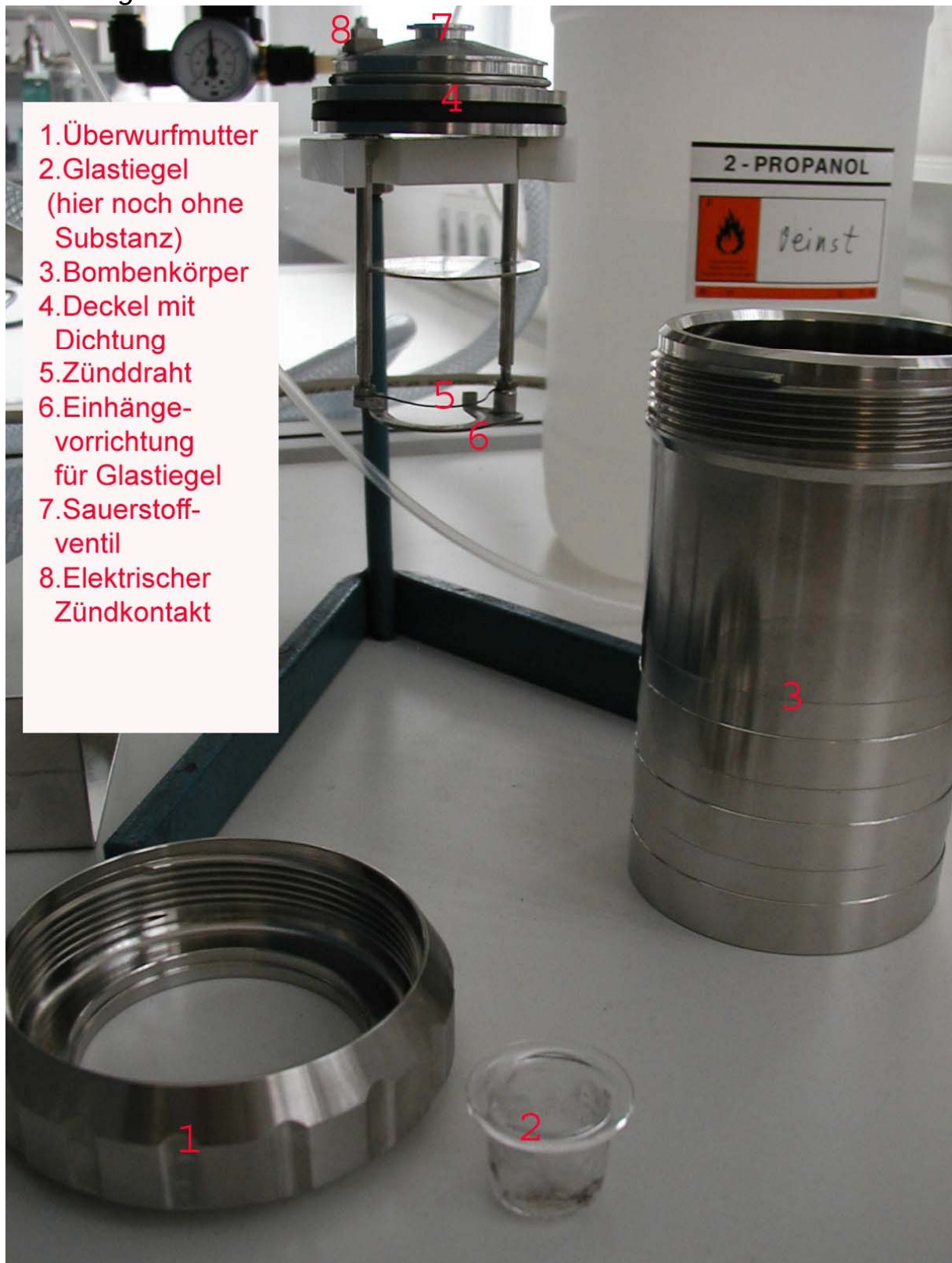
Abbildung 2: Innerer Aufbau der Kalorimeterbombe
